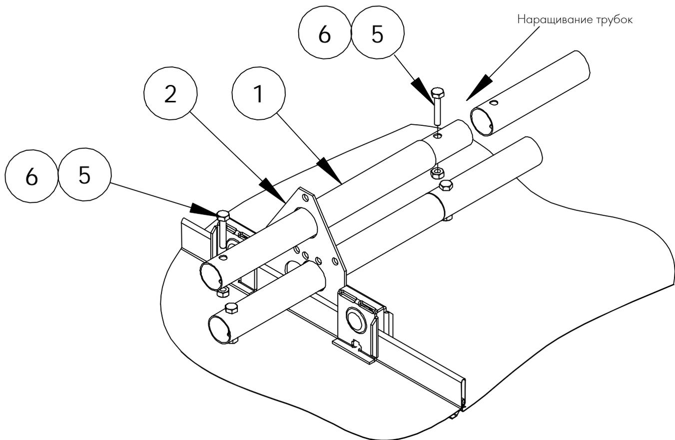
Монтаж на самозащелкивающийся фальц разных типов. Затяжка болтов крепления к фальцу: затяните опору болтами до того момента, пока не будет достигнут предел затяга. На пределе затяга стороны опоры сходятся, но не деформированы и не скручены.
